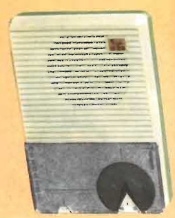
Transistor SB 61 (taschabile) - 7 Transistori + 2 Diodi - Circuiti stampati - Altoparlante mm. 70 - Potenza d'uscita 200 mW. - Batteria alimentazione 9 Volts. - Autonomia 120 h. - Mobile in plastica bicolore con custodia - Dimensioni 15x3x11,5 - Peso: Kg. 0,535.
