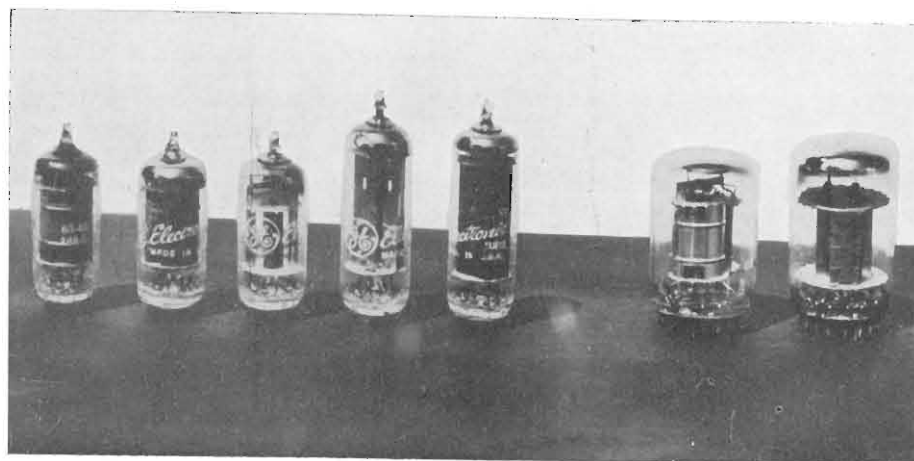
La GENERAL ELECTRIC Co. riprendendo una idea già sfruttata vent'anni fa, ha presentato recentemente dei tubi multipli denominati compactron. Nella foto: due compactron sostituiscono in un radiorecettore normale cinque tubi classici. Dei compactron torneremo a parlare in una prossima occasione.
