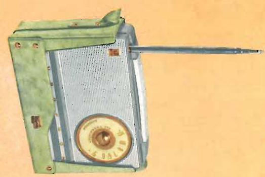
Transistor SB 61 (taschabile) - 7 Transistori + 2 Diodi - Circuiti stampati - Altoparlante mm. 70 - Potenza d'uscita 200 mW. - Batteria alimentazione 9 Volts. - Autonomia 120 h. - Mobile in plastica bicolore con custodia - Dimensioni 15x3x11,5 - Peso: Kg. 0,535.
