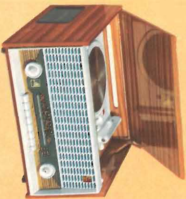
Ricevitore ES 200 (mod. di freq.) - 6 Valvole - OM-OC-FM-Fono - Giradischi a 4 velocità - Comandi a tastiera, regolazione multipla dei toni - Altoparlante elicoidale mm. 125 - pot. d'uscita 3,5 W. - Mobile in legno, frontale in plastica - Dimensioni 41 x 32,5 x 23 - Peso: Kg. 7,300.
